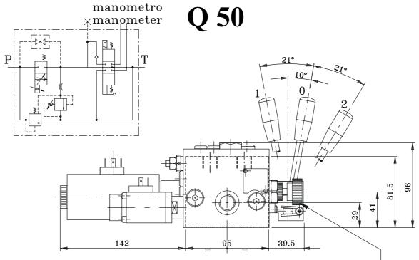
Sicurezza manuale(M) o elettrica(E) a richiesta Specificare tensione e schema dell' elettrovalvola
