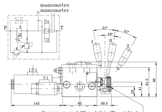
Sicurezza manuale(M) o elettrica(E) a richiesta Specificare tensione e schema dell' elettrovalvola Optional manual(M) or electrical(E) safety device Specify voltage and scheme of the solenoid operated valve
